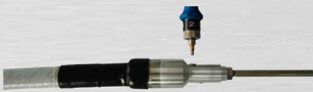
Bild 80: Zylinderkopfschraube B mit 6 Nm anziehen
