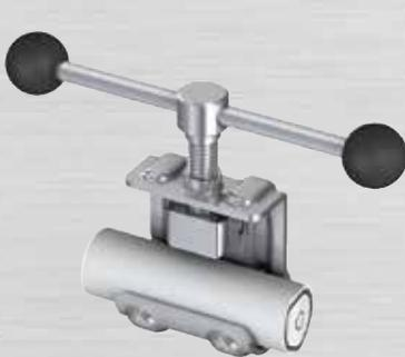
Bild 98: Schnittwerkzeug ansetzen
