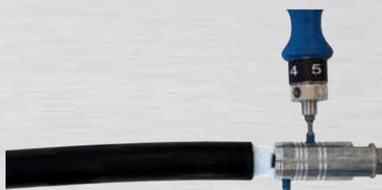
Bild 38: Gewindestift A mit 4 Nm anziehen
