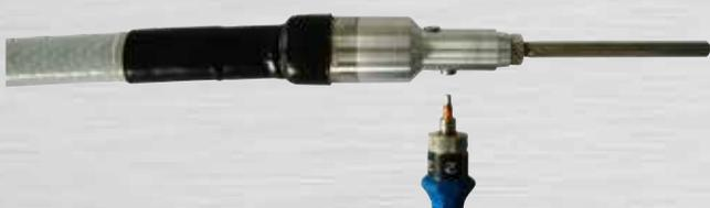
Bild 79: Zylinderkopfschraube A mit 6 Nm anziehen
