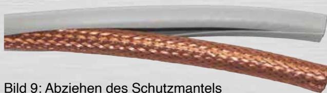
Bild 9: Abziehen des Schutzmantels
