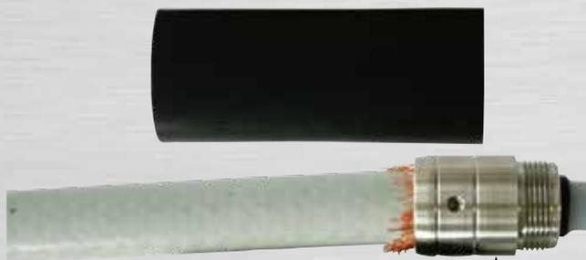
Bild 71: Angedachte Endposition des Schrumpfschlauchs (zwischen Rille und Kante)
