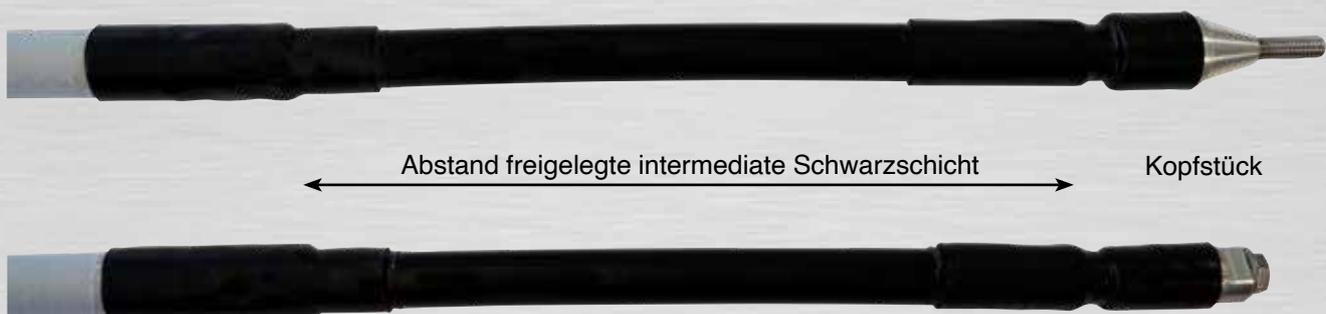
Bild 4: fertig konfektionierter Kopfbereich
