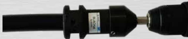
Bild 26: Laufenden Akku-Schrauber bis auf Anschlag andrücken
