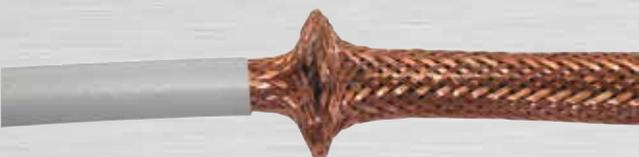
Bild 12: Bildung einer Wölbung mit ausreichender Höhe
