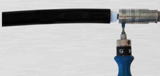
Bild 40: Gewindestift B mit 4 Nm anziehen
