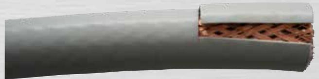
Bild 56: Abziehen des Schutzmantels
