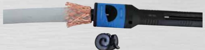
Bild 60: Abgeschälte Isolierung
