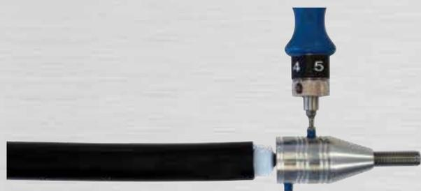
Bild 31: Gewindestift A mit 4 Nm anziehen
