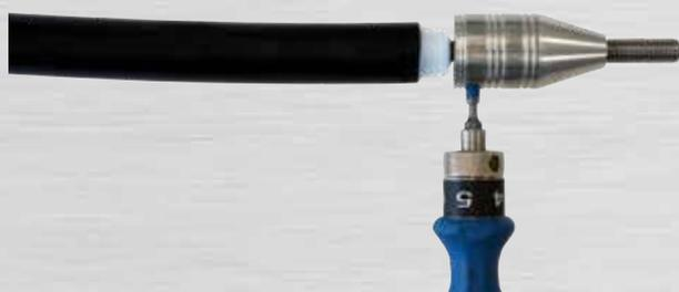
Bild 33: Gewindestift B mit 4 Nm anziehen
