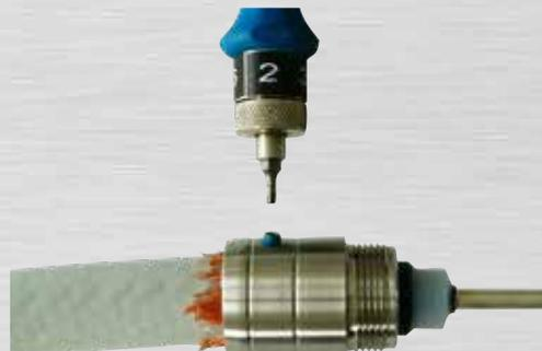
Bild 70: Gewindestift bündig einschrauben
