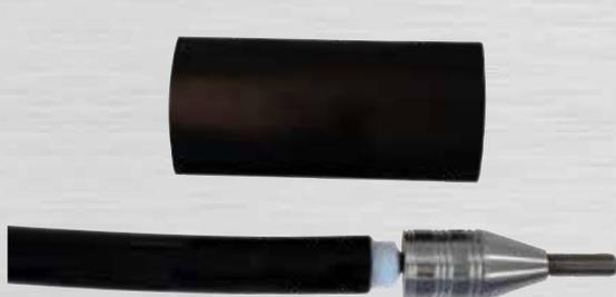
Bild 46: Positionierung des Schrumpfschlauches
