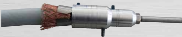
Bild 60: Aufschieben des Fußstückes
