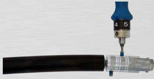
Bild 34: Gewindestift A mit 4 Nm anziehen
