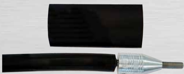
Bild 42: Positionierung des Schrumpfschlauches
