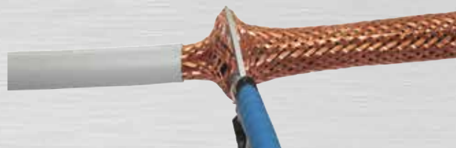
Bild 13: Durchtrennen des Schirmgeflechtes
