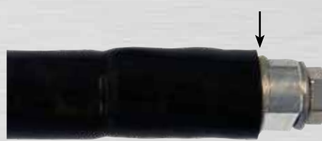
Bild 50: Gewindestifte müssen verdeckt und der Kleber ausgetreten sein
