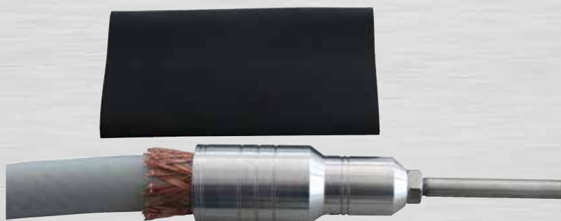
Bild 68: Positionieren des Schrumpfschlauches
