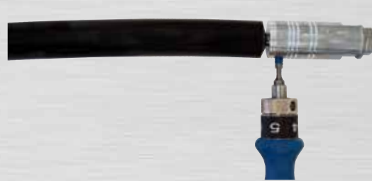
Bild 36: Gewindestift B mit 4 Nm anziehen
