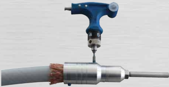
Bild 66: Gewindestift B mit 4 Nm anziehen
