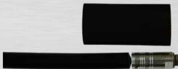
Bild 45: Positionierung des Schrumpfschlauches
