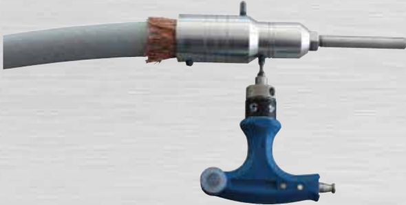
Bild 64: Gewindestift A mit 4 Nm anziehen
