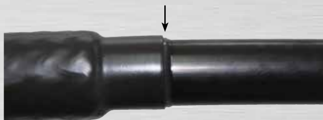
Bild 41: Kleberaustritt an der Schwarzschrift
