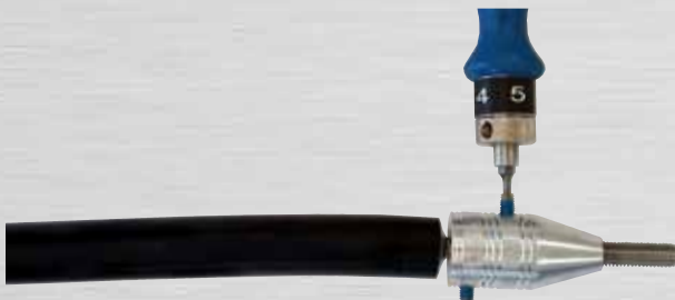
Bild 28: Gewindestift A mit 4 Nm anziehen
