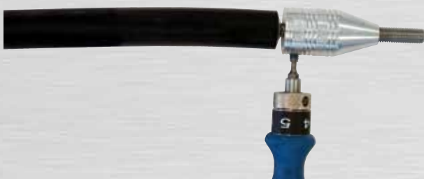
Bild 30: Gewindestift B mit 4 Nm anziehen
