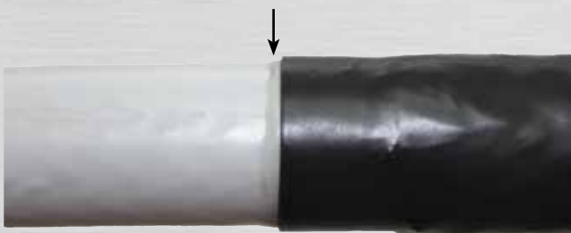
Bild 40: Kleberaustritt am Schutzmantel
