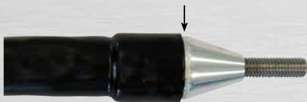
Bild 49: Gewindestifte müssen verdeckt und der Kleber ausgetreten sein
