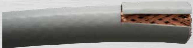
Bild 52: Abziehen des Schutzmantels
