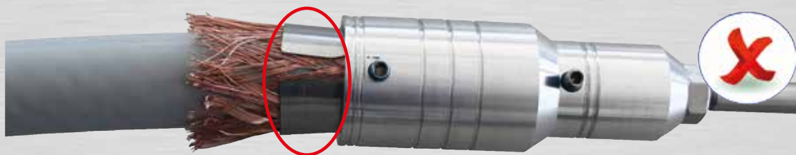
Bild 63: Falsche Positionierung von Fußstück und Kontaktblech
