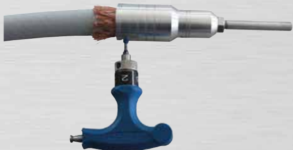
Bild 67: Gewindestift C mit 2,5 Nm anziehen
