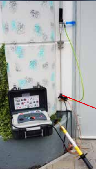
③ Funktionserdungsanschluss von Messgerät mit Erdungsfahne verbinden.
