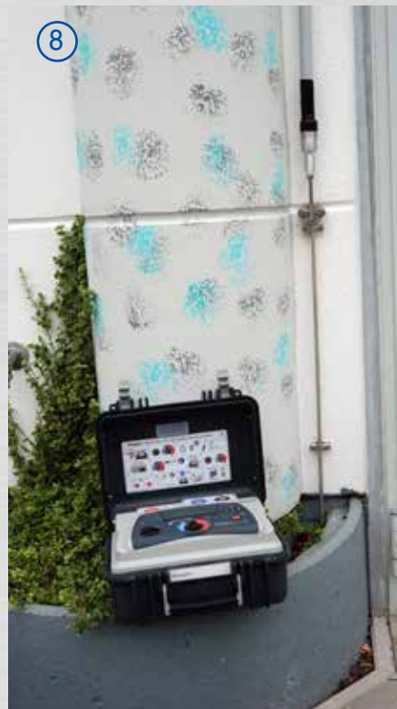
⑧ Alle restlichen Anschlüsse von der Erdungsfahne entfernen und im Messgerät verstauen.
